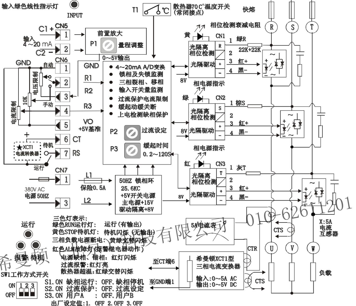
说明: 1) R1R2短路出厂配置。 2) 常闭温度开关T1不使用时, 必须短路, 否则视为超温报警。
