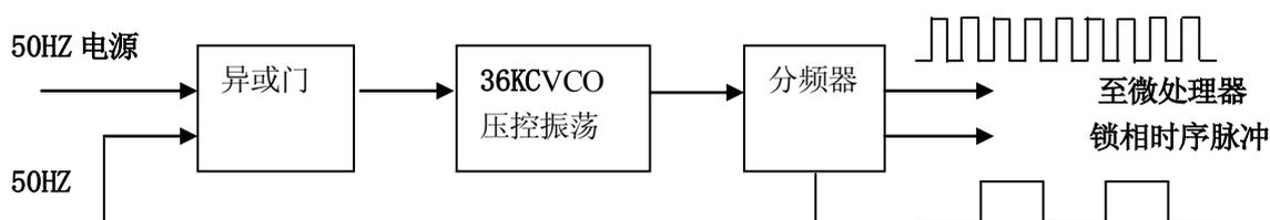
参照原理图: 异或门相位比较器将 50Hz 同步源与经压控振荡器、抗干扰积分环节后分频的 50Hz 反馈信号进行相位比较, 产生误差电压控制压控振荡器。锁相环锁定后, 50Hz 同步脉冲和计数脉冲送至微处理器, 整个时序与电源保持准确的同步。4~20 mA 输入经前置放大后的 0~5V 电压, A) 经短路片直接 R1 端 或 B) 经 R2 端, 由用户组合成手动/自动、上限电压限制送至 R1 端输入。R1 输入信号, 一路送线性 LED 输入指示, 另一路经 A/D 变换、线性校正后计算出移相角至计数器, 完成三相裂相, 脉冲分配以及光隔驱动输出。快熔端的三相电源电压经衰减电阻、光隔后进入相位检测电路, 完成自动判别相位、缺相和快熔断路检测。采用中心门极 (导通快、均匀) 大功率调相固态继电器和直流可变脉宽触发, 因而可控制感性负载。体现各种负载的控制策略也可由功能强大的微处理器实现。
